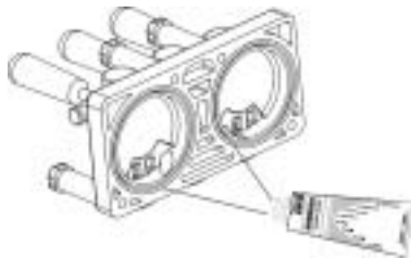
Picture 17: discharge door lubrication
